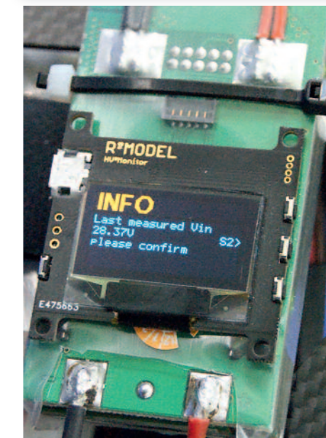
Sinnvoll: Wenn beim letzten Betrieb die minimale Eingangsspannung unterschritten wurde, wird dies angezeigt und der Benutzer aufgefordert, die Meldung zu bestätigen, um das Modell wieder in Betrieb zu nehmen.
